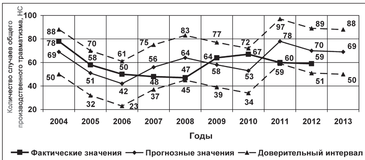
Рис. 3. – Динамика и ретроспективный прогноз общего производственного травматизма на шахте «Холодная Балка» ГП «Макеевуголь» за 2004 – 2012 гг. и прогноз на 2013 г. (для объема угледобычи 570,0 тыс. тонн в год)
