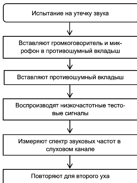
Рисунок 6 — Блок-схема для испытания на утечку звука
