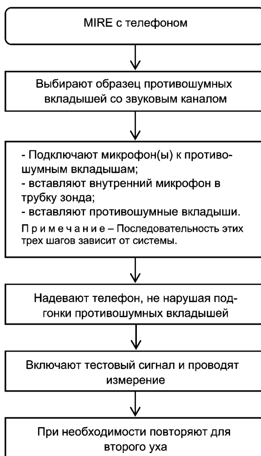
Рисунок 1 — Блок-схема для метода 1а
