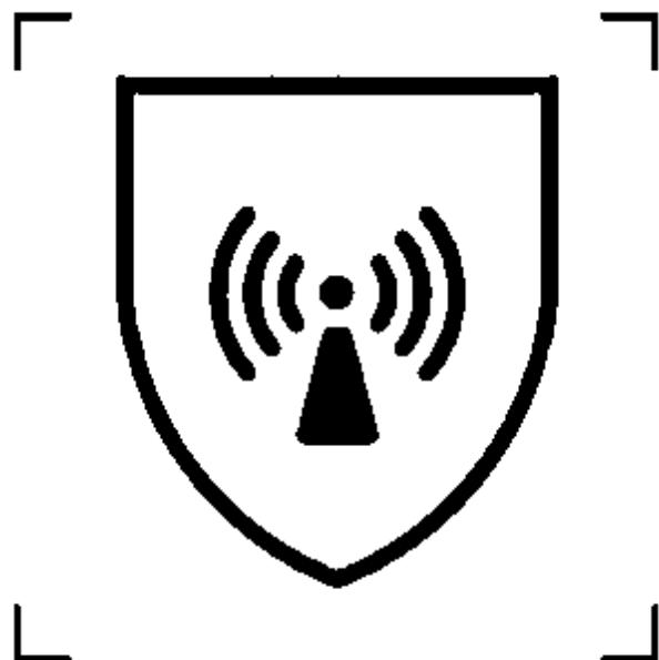
Буквенное обозначение защитных свойств комплектов от электромагнитных полей радиочастотного диапазона - "ЭМ".
