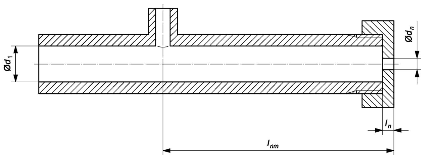
$d_n$  - диаметр отверстия сопла, равный  $(4,0 \pm 0,1)$  мм;  $l_n$  - длина отверстия сопла, равная  $(4,0 \pm 0,1)$  мм;  $d_1$  - внутренний диаметр трубки, равный  $(2,5 \pm 1,0)$  мм;  $l_{nm}$  - расстояние между отверстием сопла и манометром, равное  $(80 \pm 1)$  мм
